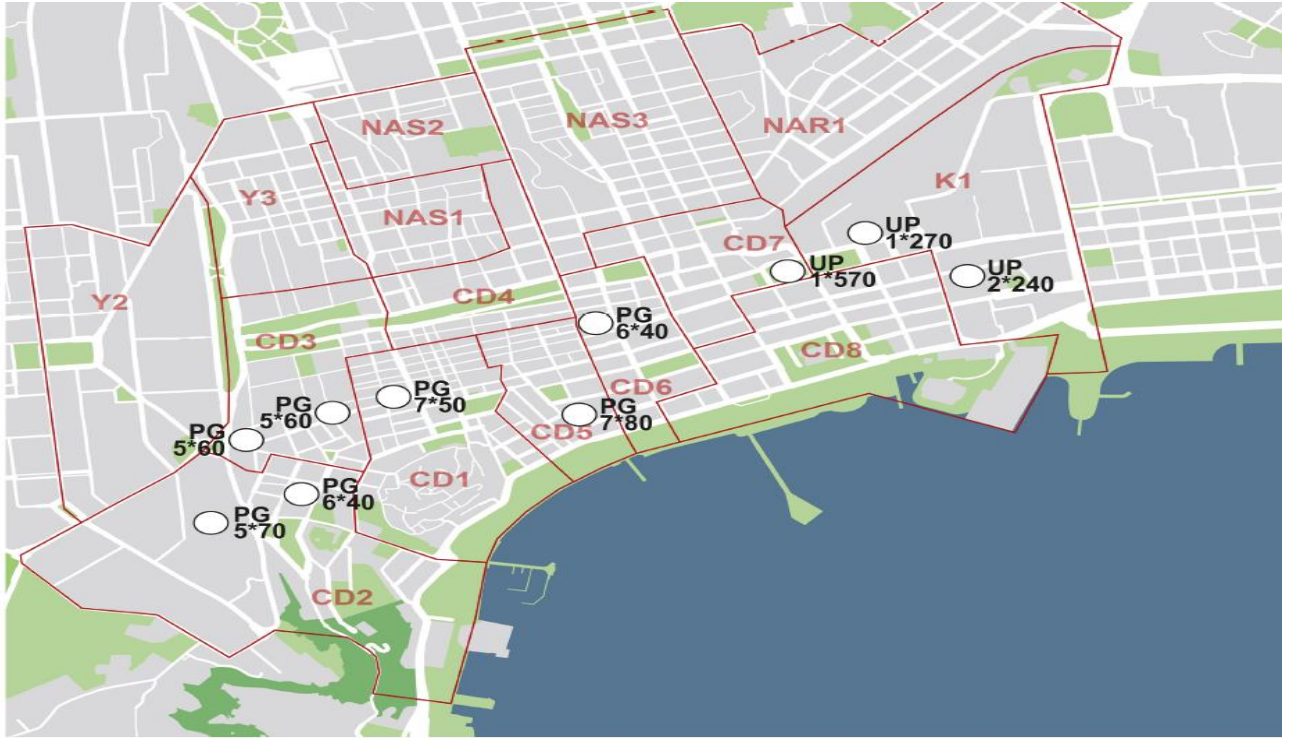
2040-ci il üzrə gələcəyə baxış – Təklif olunan avtomobil dayanacaqlarının yerləşməsi (PG: avtomobil qarajı, UP: yeraltı avto-dayanacaq; mərtəbə sayı * hər mərtəbədə dayanacaq yerləri)
